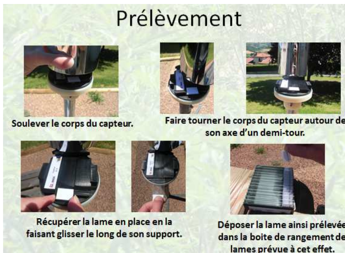
Figure 2 : procédure de changement des lames
