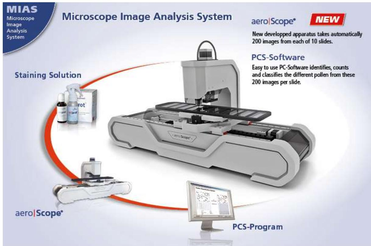
Une platine sur laquelle peuvent être posées 10 lames est montée sur un rail qui fait défiler la lame devant l'objectif. Les prises de vue peuvent être programmées en fonction des besoins, pour l'instant l'appareil travaille sur 100 photos par ligne d'analyse.
