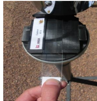
Récupérer la lame en place en la faisant glisser le long de son support.
