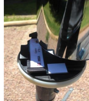
Faire tourner le corps du capteur autour de son axe d'un demi-tour.
