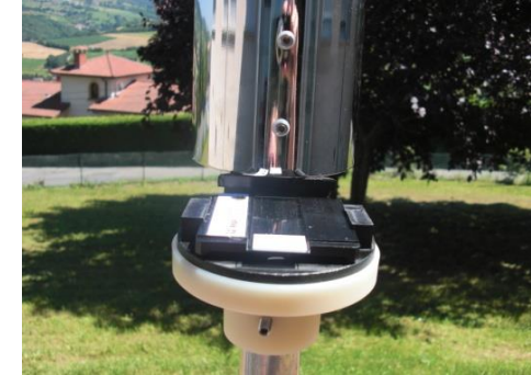
Faire tourner le corps du capteur autour de son axe d'un demi-tour.
