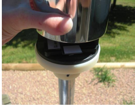
Soulever le corps du capteur.
