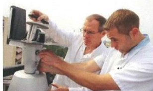
Récupération du filtre à particules du capteur de pollens placé sur le toit de l'hôpital Legouest
